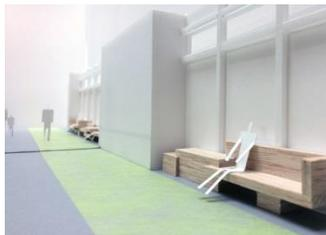
CLTは、立てれば柱や壁となり、横にすれば床や梁の役割を果たす特徴から、建物の様々な箇所に利用でき、子供の玩具であるブロックのように、積み重ねたり、組合せたりできる木質材料である。このベンチは、そのようなブロック玩具を着想に、2種類のブロックパーツ「パネル」と「かたまり」を基本構成とし、ブロックの形状や組合せを変化させる事で、様々な場面に展開できるように設計している。
