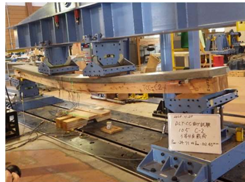
②DLT-コンクリート複合梁強度試験
