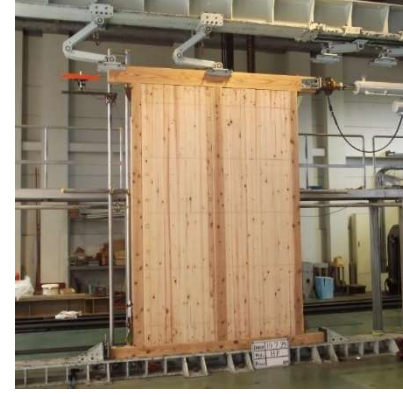
③壁の面内せん断強度試験
