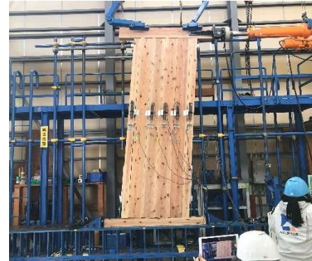
③壁の面内せん断強度試験
