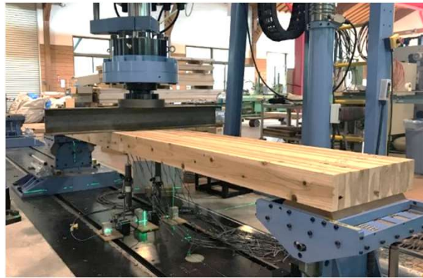
②床の曲げ強度試験
