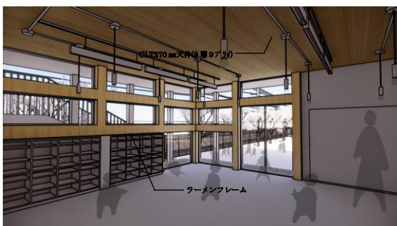
▲2歳児保育室 CLT+ラーメンフレームの無柱空間
