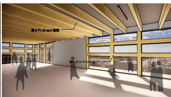
▲4・5歳児保育室 燃え代小屋梁+ラーメンフレームの無柱空間
