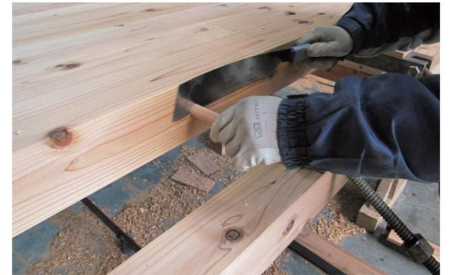
DLT製造の様子(ダボ端部カット作業)
