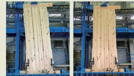
面内せん断試験状況(加力前、加力後)
