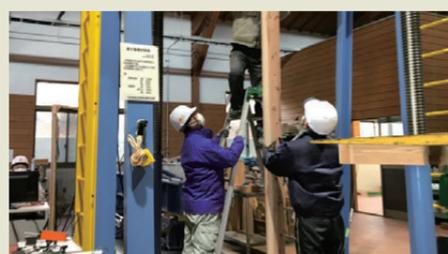
組立柱の加力試験状況
