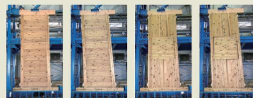
面内せん断試験状況(加力前、加力後)
