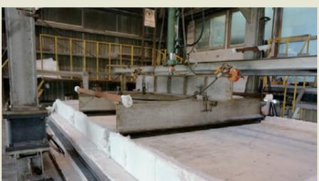
載荷加熱試験状況
